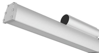
Светодиодный светильник Эслайт XA-street разработан для наружного освещения улиц, придомовых, садово-парковых территорий и промышленных объектов. Предназначен для монтажа креплениями типа “Консоль” и “Кронштейн”. Корпус светильника выполнен из алюминия и АБС-пластика. Рассеиватель изготовлен из светотехнического ударопрочного полистирола. Пульсация светового потока не более 1%. Светильник не создает радиопомехи и электромагнитные помехи.
