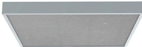
Светодиодный светильник Эслайт L-24 разработан для внутреннего освещения общественных зданий. Предназначен для монтажа в потолок типа “АРМСТРОНГ” и накладным способом. Корпус светильника выполнен из листовой стали с порошковой покраской. Рассеиватель изготовлен из светотехнического ударопрочного полистирола типа “Призма”, возможны варианты “Микропризма”, “Колотый лед”, “Опал”.
