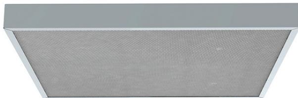
Светодиодный светильник Эслайт L-32 разработан для внутреннего освещения общественных зданий. Предназначен для монтажа в потолок типа “АРМСТРОНГ” и накладным способом. Корпус светильника выполнен из листовой стали с порошковой покраской. Рассеиватель изготовлен из светотехнического ударопрочного полистирола типа “Призма”, возможны варианты “Микропризма”, “Колотый лед”, “Опал”.
