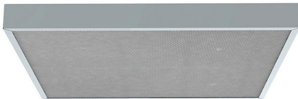
Светодиодный светильник Эслайт L-51 разработан для внутреннего освещения общественных зданий. Предназначен для монтажа в потолок типа “АРМСТРОНГ” и накладным способом. Корпус светильника выполнен из листовой стали с порошковой покраской. Рассеиватель изготовлен из светотехнического ударопрочного полистирола типа “Призма”, возможны варианты “Микропризма”, “Колотый лед”, “Опал”.
