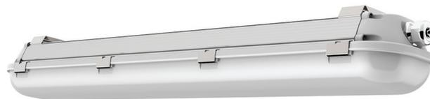
Светодиодный светильник Эслайт Techno1 разработан для внутреннего и наружного освещения общественных зданий. Предназначен для монтажа накладным способом. Корпус светильника выполнен из алюминия, окрашен порошковой покраской белого цвета (RAL9016). Рассеиватель изготовлен из светотехнического ударопрочного полистирола типа "Матовый".
