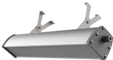
Светодиодный светильник Эслайт ХА разработан для освещения промышленных объектов. Предназначен для монтажа креплениями типа “Кронштейн”. Корпус светильника выполнен из алюминия и АБС-пластика. Рассеиватель изготовлен из светотехнического ударопрочного полистирола. Пульсация светового потока не более 1%. Светильник не создает радиопомехи и электромагнитные помехи.
