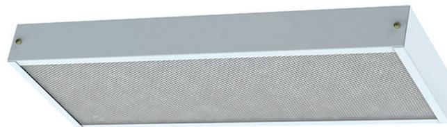
Светодиодный светильник Эслайт S1 разработан для внутреннего освещения общественных зданий. Предназначен для монтажа накладным способом. Корпус светильника выполнен из листовой стали с порошковой покраской. Рассеиватель изготовлен из светотехнического ударопрочного полистирола типа "Призма", возможны варианты "Микропризма", "Колотый лед", "Опал".
