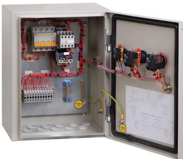
Ящики управления типа Я5000 (РУСМ5000, ЩУ5000) предназначены для местного, дистанционного и автоматического управления асинхронными электродвигателями с короткозамкнутым ротором мощностью до 75 кВт, работающими в продолжительном, кратковременном и повторно-кратковременном режимах. Ящики управления РУСМ5000 применяются в помещениях с высокой влажностью и изготавливаются со степенью защиты IP54.
