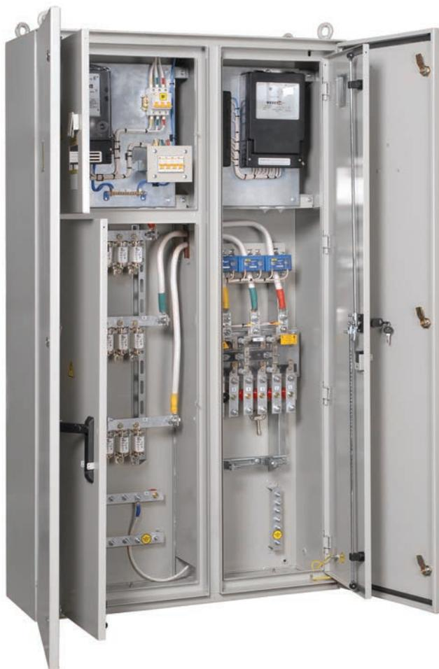
Вводно-распределительные устройства ВРУ-8503, ВРУ-8504, ВРУ-8505 для жилых и общественных зданий предназначены для приема, распределения и учета электро-энергии трехфазного переменного тока напряжением 400/230 В частотой 50 Гц с глухозаземленной нейтралью, для защиты групповых линий при перегрузках и коротких замыканиях, а также нечастых оперативных включений и отключений электрических сетей.
