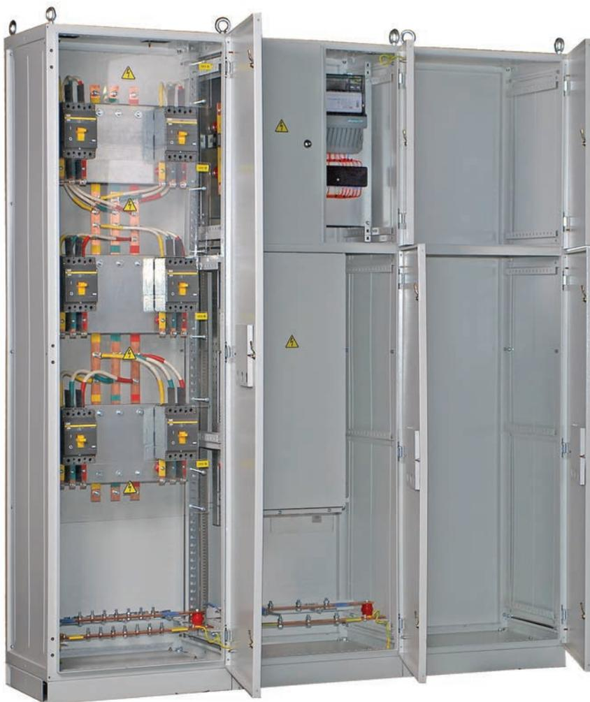
Учетно-распределительное устройство ЗУР-200 предназначено для контроля, распределения и разделения учета электрической энергии на нежилых этажах жилых домов и отдельных помещениях в административных зданиях в сети напряжением 400/230 В с глухозаземленной нейтралью трехфазного переменного тока частотой 50 Гц.
