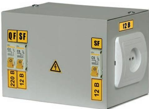
Ящики с понижающим трансформатором предназначены для питания сетей местного освещения напряжением 12 В, 24 В, 36 В или 42 В. Максимальная суммарная мощность 250 ВА.
