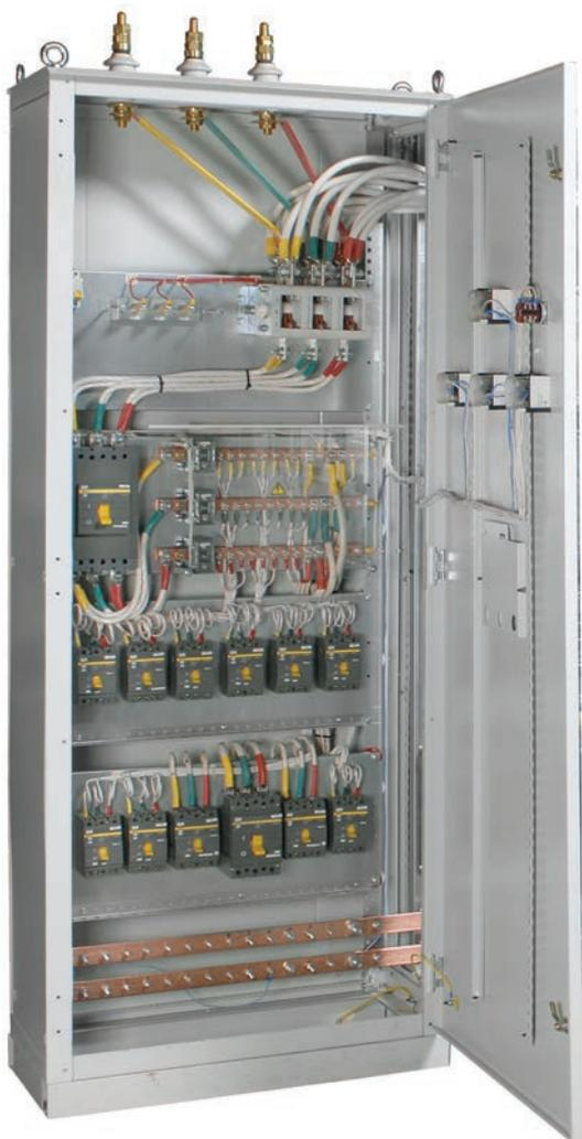
Вводно-распределительные устройства ВРУ-1, ВРУ-3 предназначены для приёма, рас-пределения и учёта электроэнергии в сетях 400/230 В с глухозаземленной нейтралью трехфазного переменного тока частотой 50 Гц; для защиты потребителей от токов перегрузки и токов короткого замыкания; для нечастых оперативных включений и отключений электрических сетей.
