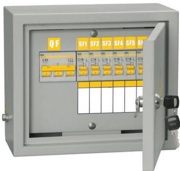
Щитки осветительные типа ОЩВ(УОЩВ) применяются в осветительных сетях напряжением 400/230 В промышленных и общественных зданий для распределения электроэнергии, защиты от перегрузок и токов короткого замыкания групповых линий, защиты от поражения электрическим током. Могут быть выполнены навесного (ОЩВ) и встраиваемого (УОЩВ) исполнения.
