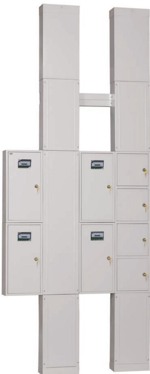
Устройство УЭРМ предназначены для установки на этажах жилых зданий и служат для приема, распределения и учёта электрической энергии напряжением 400/230 В переменного тока частотой 50 Гц в сетях с глухо-заземлённой нейтралью и для защиты линий электроснабжения жилых помещений от токов перегрузки и коротких замыканий, защиты от поражения электрическим током.
